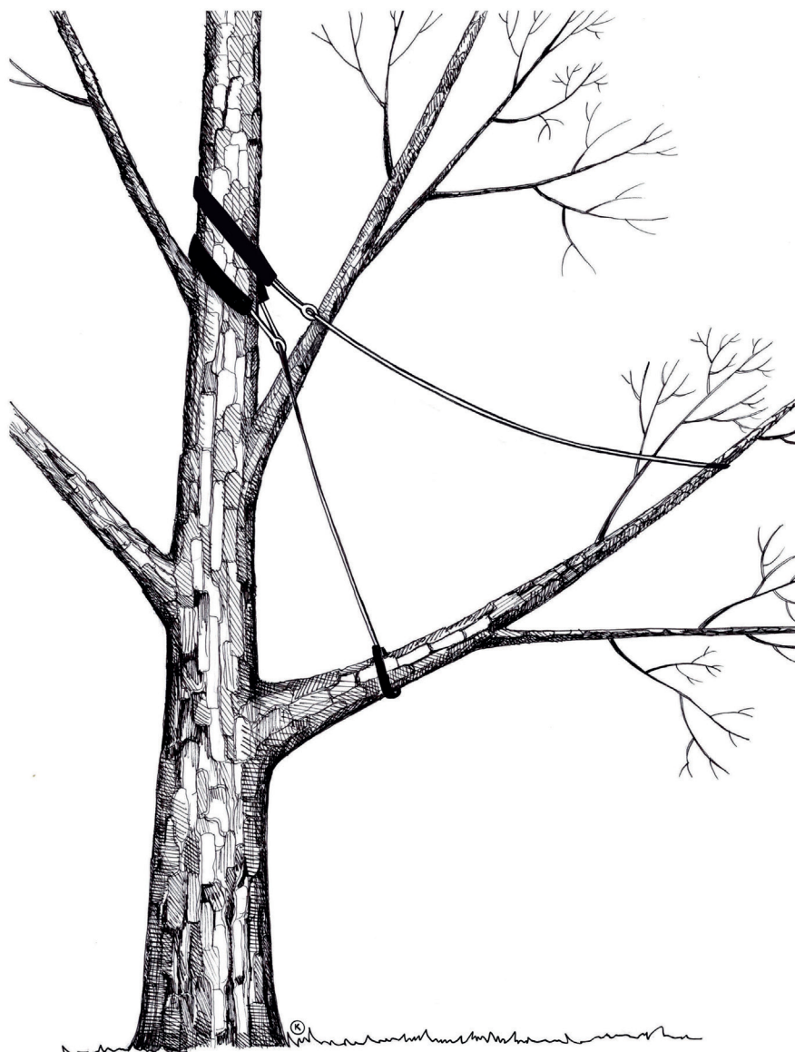
Rysunek 6: Zabezpieczenie poziomej gałęzi zapobiegające powstaniu szkód w razie jej upadku
