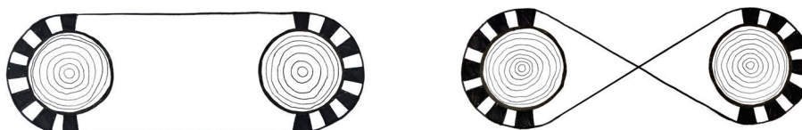
Rysunek 16: Zalecane sposoby montażu systemu opartego na linie z podkładkami
